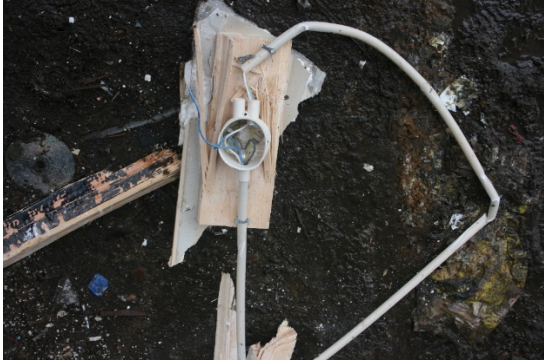
Figur 20. Exempel på hårdplast rivningsavfall (prov 1) från en förskola byggt på 1970-talet.
