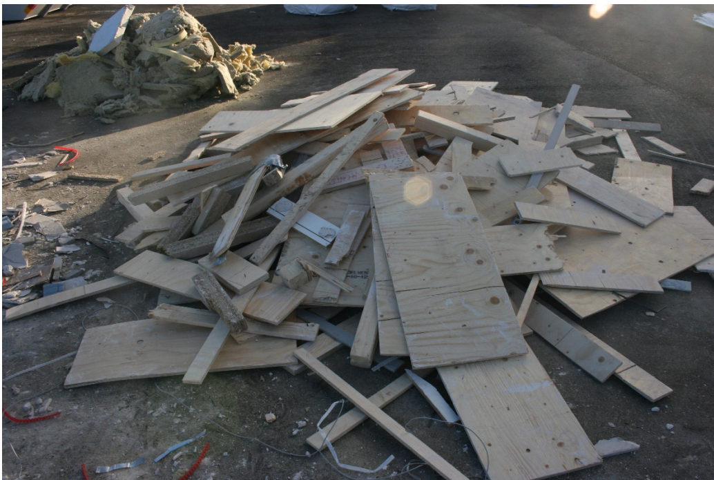
Figur 40. Trä- konstruktionsvirke utsorterade vid plockanalysen av brännbart rivningsavfall (prov 2). Den totala mängden trä- konstruktionsvirke som sorterades ut uppgick till 13,9 kg.
