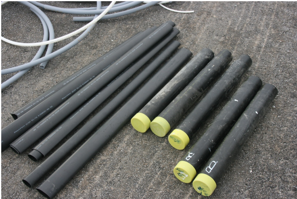
Figur 50. Plast: rör (hårda) utsorterade vid plockanalysen av brännbart byggavfall (prov 2). Den totala mängden Plast: rör (hårda) som sorterades ut uppgick till 10 kg.
