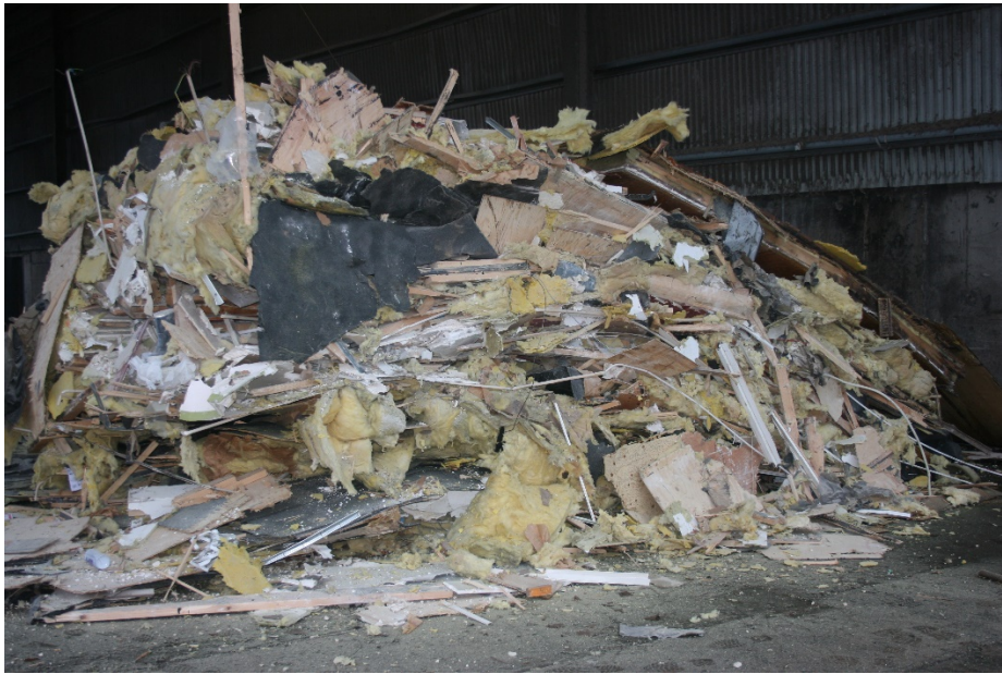
Figur 10 Mottaget brännbart rivningsavfallprov 1-total rivning av en förskola byggd på 1970 talet.
